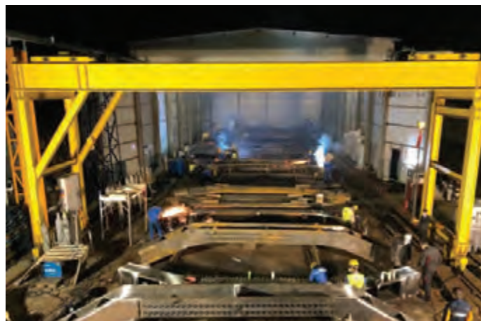
Izrada pilonskih sedala u tvornici
