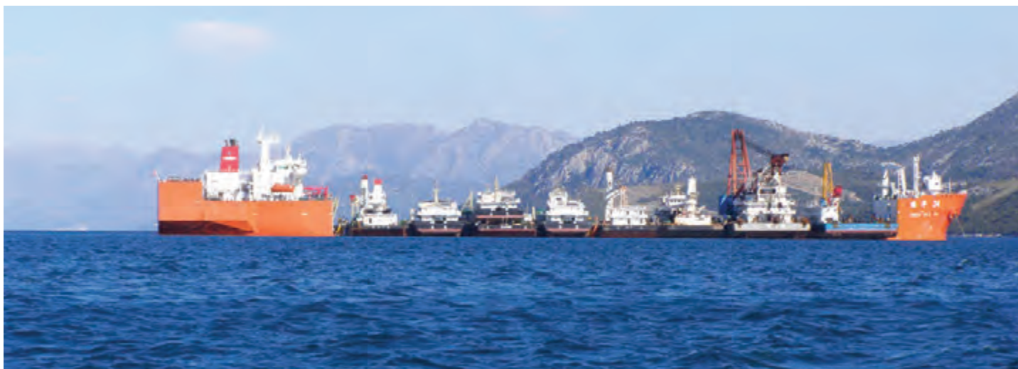
Ožujak 2019.: plovila za izgradnju mosta dopremljena su na gradilište polupotopnim brodom
