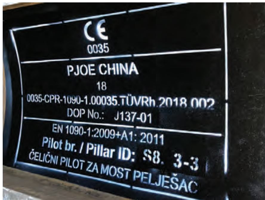
Proizvodnja pilota u kineskoj tvornici bila je certificirana prema regulativi EU, stoga je proizvođač mogao na njih staviti oznaku CE građevinskog proizvoda.
