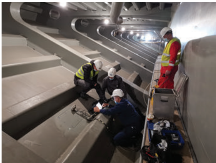
Kontrola zavora ultrazvučnim uređajem u unutrašnjosti mosta.
