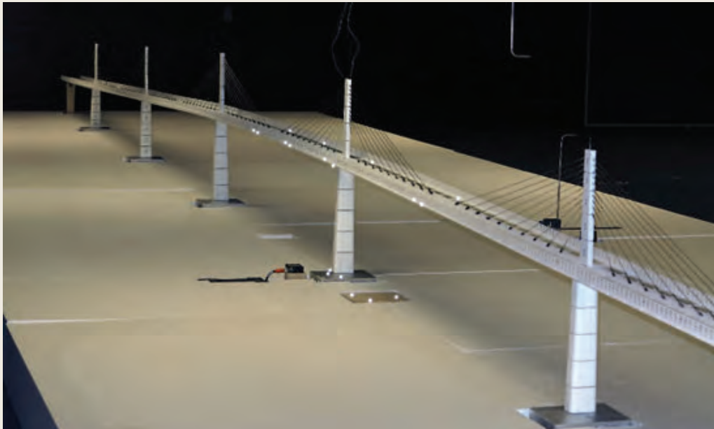
Testiranje modela mosta u vjetrovnom tunelu.
